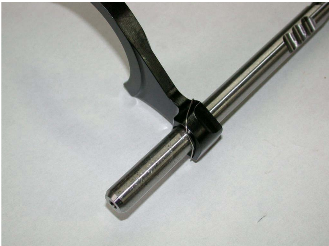
Foto 6 – Fotografia del bloccaggio del bullone di fissaggio sull'asta 3°-4°. Eseguire la stessa procedura sull'asta e sulla forcella 1°-2°.
