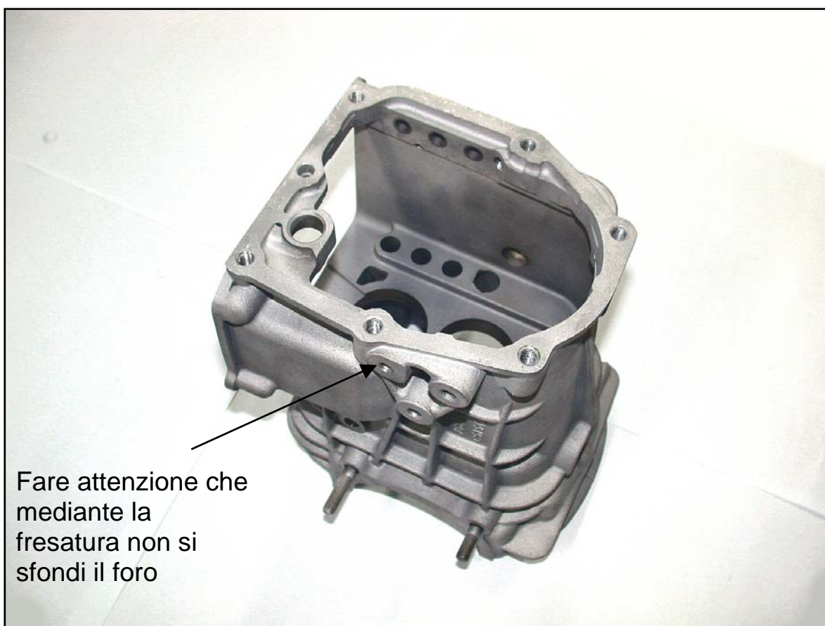
Foto 2 – Porre particolare attenzione a non arrivare fino al fondo della filettatura segnata.
